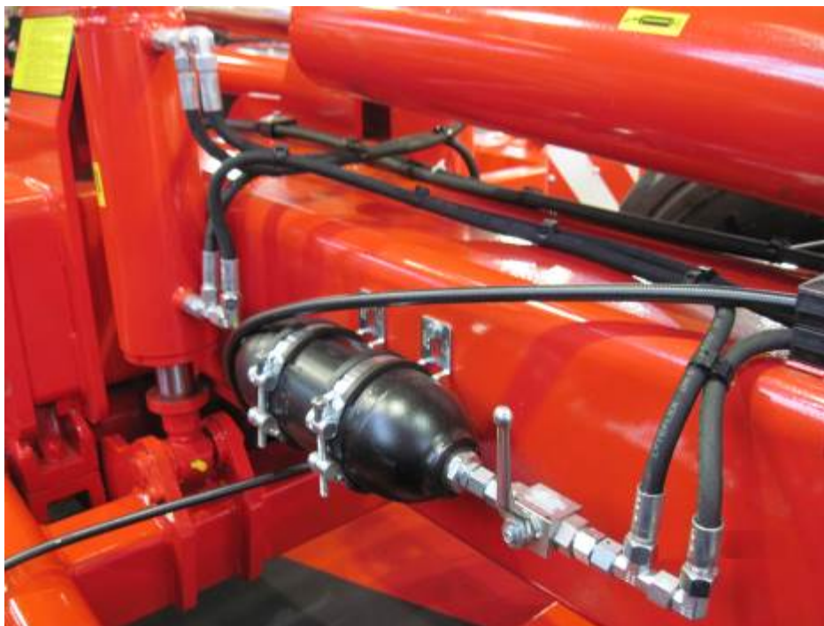
Рисунок 6. Азотный гидроаккумулятор опорных колес в рабочем положении
